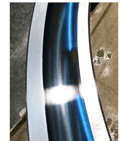
Die Oberflächenschicht der Laufbahnen ist angepasst, damit die Reibung geringer und die Wärmeentwicklung eingeschränkt ist.
