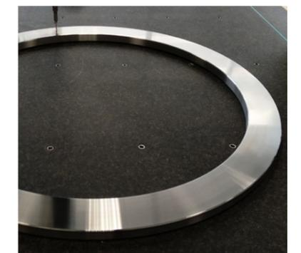
**Ebenheitsmessung** einer Anlaufscheibenlaufbahn.
