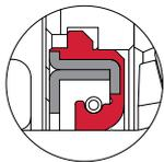
Premium-Elastomerdichtung, federbelastete Kontaktlippe.
