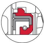
Premium-Elastomerdichtung, federbelastete Kontaktlippe.
