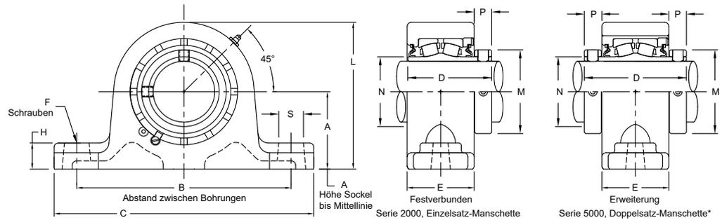
**Abmessungen des Wälzlagers (mm)**
