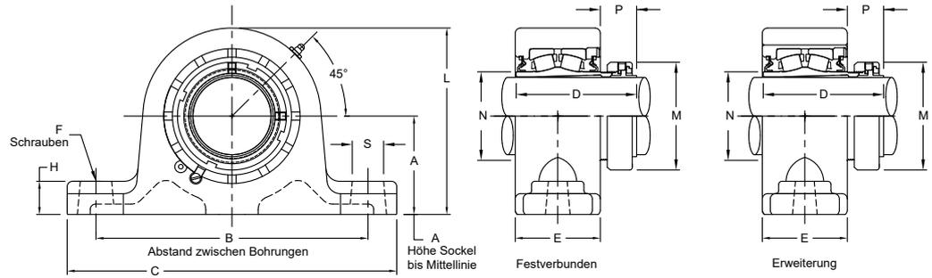
**Abmessungen des Wälzlagers (mm)**
