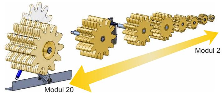
Die Schmierzahnsegmente werden auf einer Gleitbuchse angeordnet. Die Gleitbuchse rotiert auf der Befestigungsachse, welche so angeordnet ist, dass die Zähne des Schmierzahnrades komplett auf den Zahnflanken des Antriebsritzels abrollen. Durch eine Bohrung in der Befestigungsachse wird der Schmierstoff den Auslassbohrungen des **LUBCON LubeGearSystem** Schmierzahnrades zugeführt.
