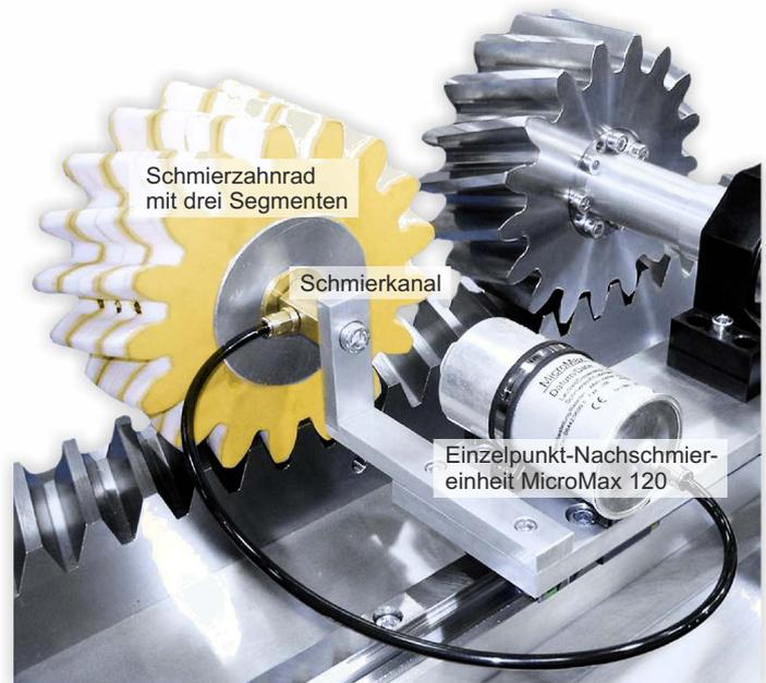
Das **LUBCON LubeGearSystem** kann sowohl mit Einzelpunkt-Nachschmiereinheiten, als auch mit Zentralschmieranlagen betrieben werden. Gegenüber manueller Schmierung ist das **LUBCON LubeGearSystem** eine preisgünstige, einfache und effektive Lösung für das gleichmäßige Auftragen von Schmierstoff.
