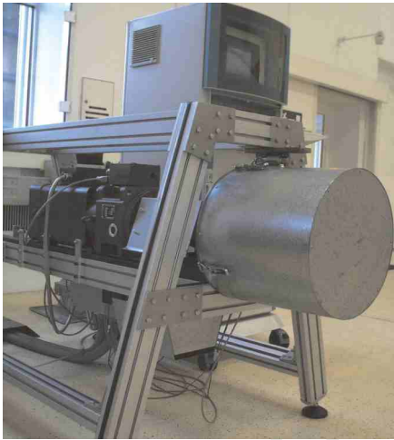
Diagramm 8: FE8-Prüflauf mit Kegelrollenlager 536048 ( \cong 31312); Axiallast F_a = 10 kN; Drehzahl n = 3000 min -1 ; Laufzeit 500 h Schmierung mit THERMOPLEX® 2 TML
