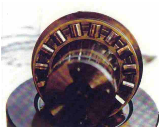
Abb. 2 und 3: Prüflager und Vorheizbehälter nach dem FAG FE8-Prüflauf: es ist keine Rückstandsformation auf den Lager- und Prüfstands- teilen sowie auf dem Vorheizbehälter zu erkennen
